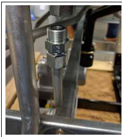
Figura 27: Conjunto de conexión Parker
