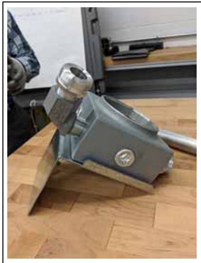
Figura 11: Conjunto de caja de empalmes con uniones (Q10016-05)
