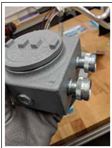
Figura 10: Conjunto de caja de empalmes con uniones (Q10016-04)
