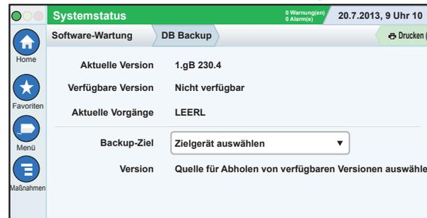
Schließen Sie Ihren USB-Stick (mind. 4 GB) an einen USB-Anschluss an und berühren sie den Pfeil nach unten im Feld "Backup-Ziel", um den USB-Stick auszuwählen und folgen Sie anschließend den Bildschirmanweisungen, um die TLS4-Daten zu sichern.
