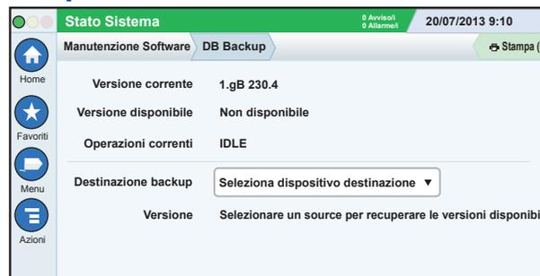
Inserire la chiavetta (minimo 4 GB) in una porta USB e toccare la freccia giù del campo Seleziona sorgente per selezionare la chiavetta, quindi seguire le istruzioni su schermo per eseguire il backup dei dati della console TLS4.
