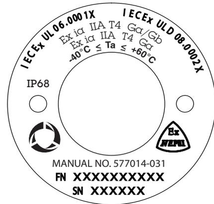
ETIQUETA IECEx DEL SENSOR DEL SUMIDERO MAG Y DE LA SONDA MAG PLUS
