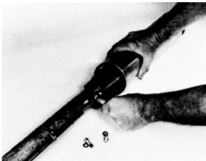
FIGURE 4.2 DÉPOSE DE L'UNITÉ POMPE/MOTEUROMBA
