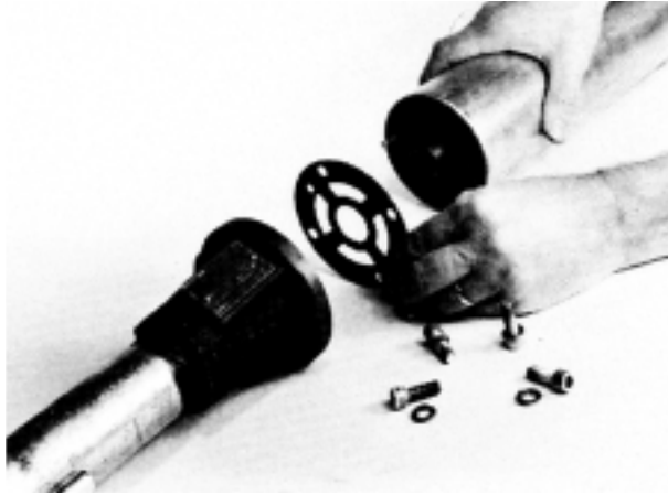
FIGURA 4.3 REEMPLAZO DEL EMPAQUE
