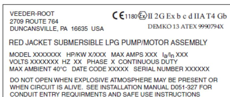
На корпусе насоса должны находиться название и адрес производителя, модель, серийный номер и код даты, данные по мощности в л.с. (кВт), число оборотов, производительность, номер EAC сертификата, а также предупреждающие надписи.
