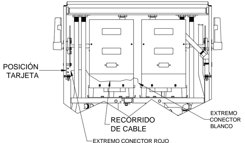
9. Recoger el sobrante del otro extremo del cable. Correr el cable por detrás del conductor y conectar el conector rojo en la tarjeta así como indica el dibujo abajo.
