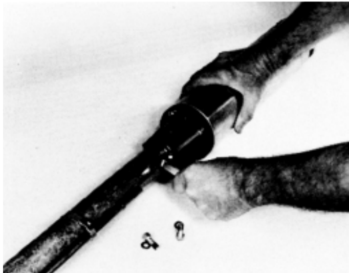
FIGURA 4.2 RETIRO DEL MONTAJE DEL MOTOR-BOMBA
