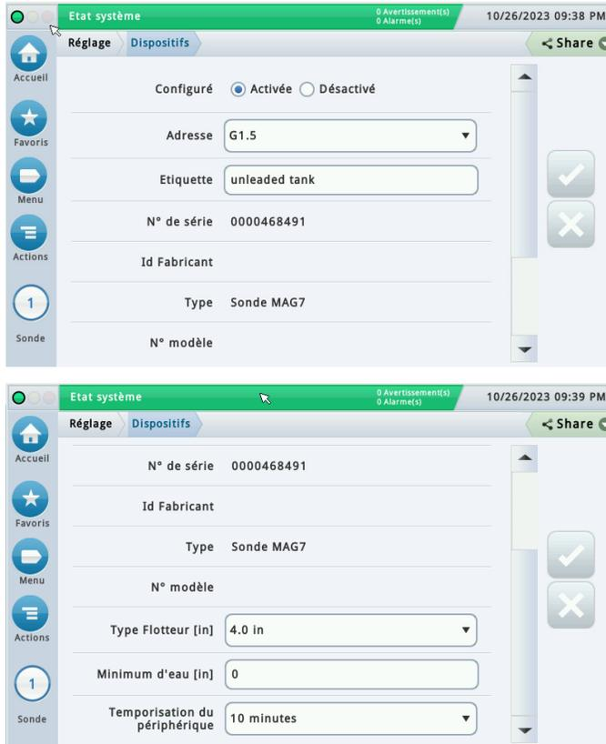
**Figure 45. Exemple d'écran de configuration de dispositif sans fil**
