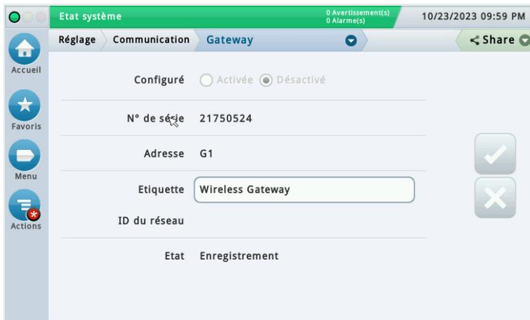
Figure 21. Écran d'enregistrement de la passerelle de rechange
