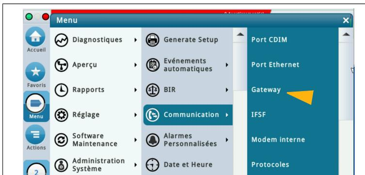
Figure 14. Accès à l'écran de configuration de la passerelle
