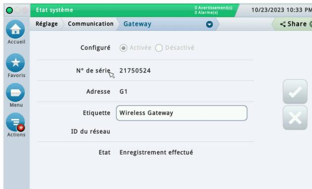
**Figure 25. Reconfiguration de la passerelle avec le nouvel ID du réseau**
