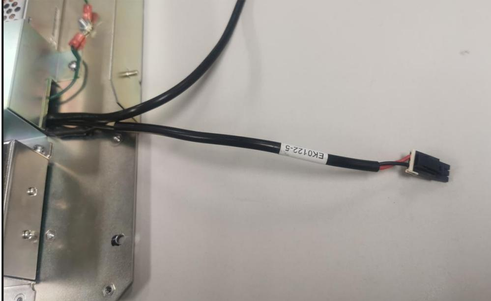
7. Insérez le connecteur noir du câble CC EK0122 dans la prise « 24 V » 1x3 voies située sur le dessus du convertisseur InvencoLink.
