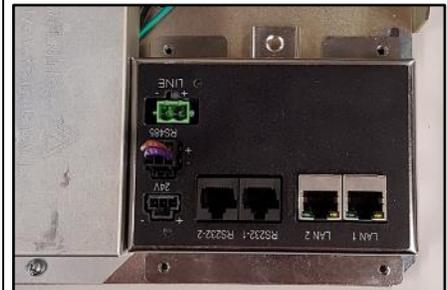
4. Prenez les quatre équipages MS0143 S du kit de mise à niveau du convertisseur InvencoLink et insérez-les dans les quatre trous du convertisseur InvencoLink :
