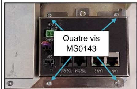
5. Serrez soigneusement les quatre vis pour fixer le capot de borne et le convertisseur InvencoLink en place. Vous devrez peut-être bouger un peu les pièces pour obtenir un bel alignement.
