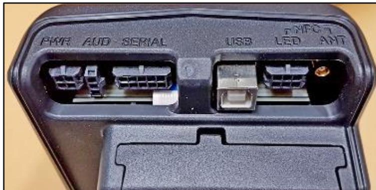
Tous les câbles du panneau RFK d'affichage sont préinstallés et tissés, et chaque connecteur est différent afin qu'il ne puisse y avoir aucune mauvaise connexion.
