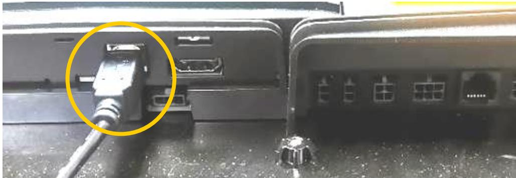
22. Si cette installation dispose d'un clavier ADA (situé à côté du module Sans contact sur le panneau RFK sans contact), insérez le câble de connexion ADA (en bas à gauche) de ce module dans la prise ADA du panneau RFK d'affichage.
