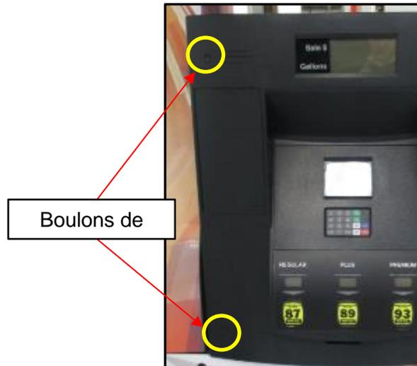
emplacement des boulons de sécurité
