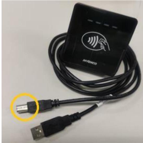
Insérez le connecteur de type B dans la prise " APC-USB » du module d'affichage (SDC).
