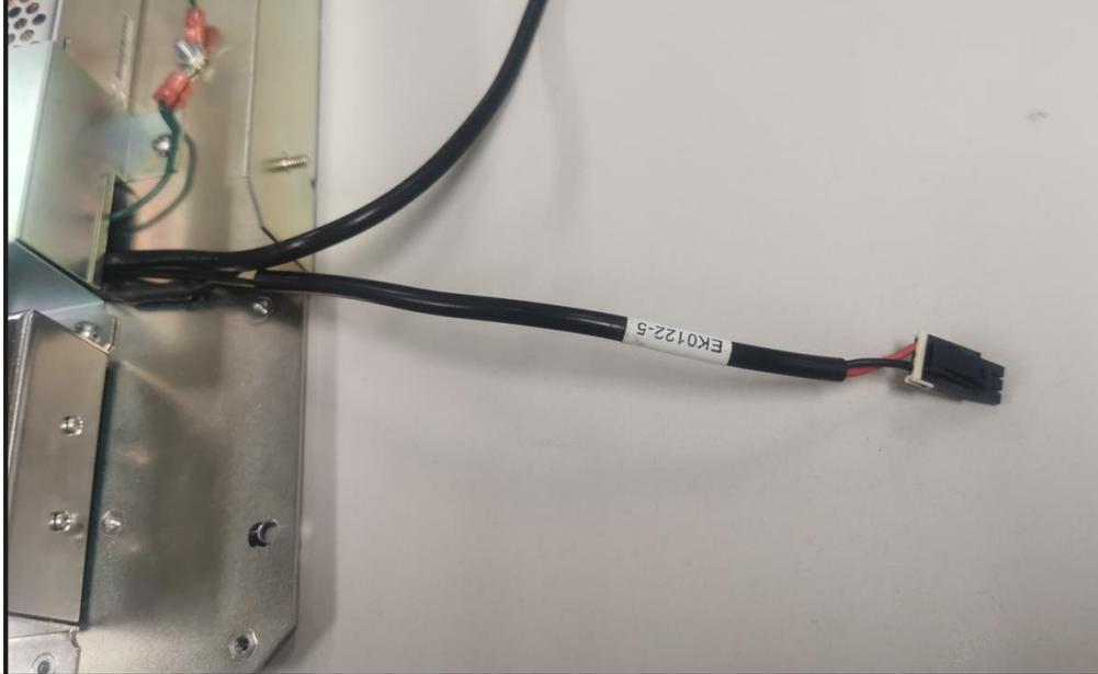
7. Insérez le connecteur noir du câble CC EK0122 dans la prise 1x3 voies « 24V » située sur le dessus du convertisseur InvencoLink .
