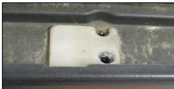
Fig 4.7 c – Upper hinge pin.
