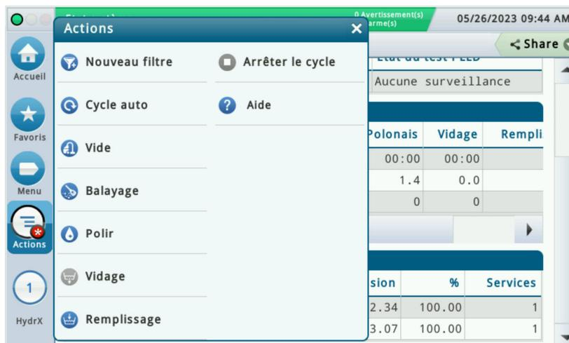
**Figure 6. Menu Actions de la Vue d'ensemble du diagnostic HydrX**
